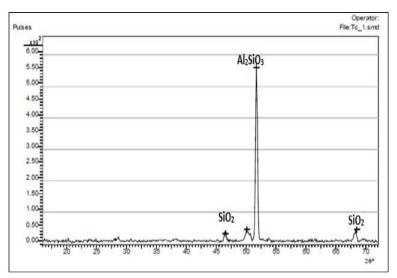
Plate 3 : XRD spectrum for Feldspar
